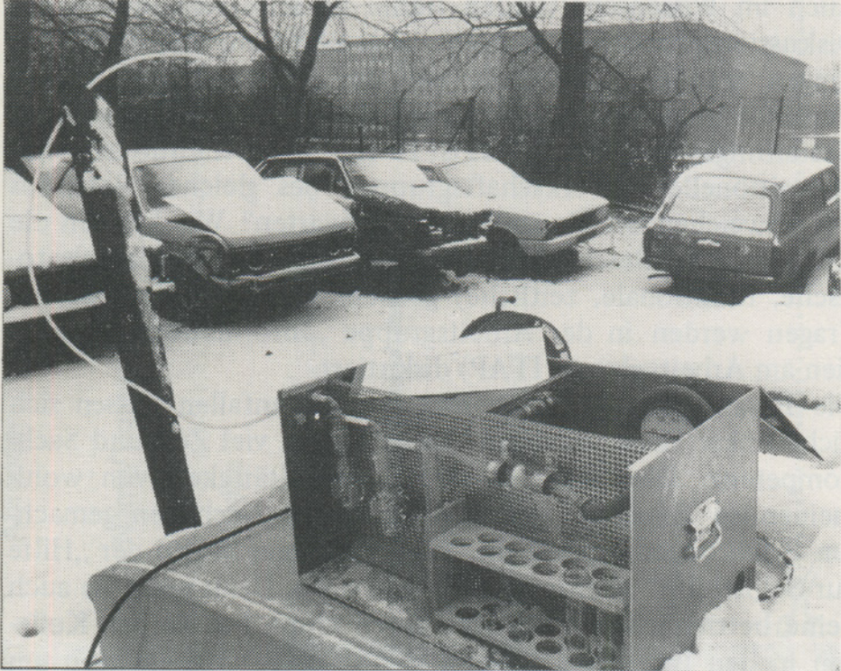
Meßgerät zur Bestimmung des SO 2 -Gehalts der Luft
