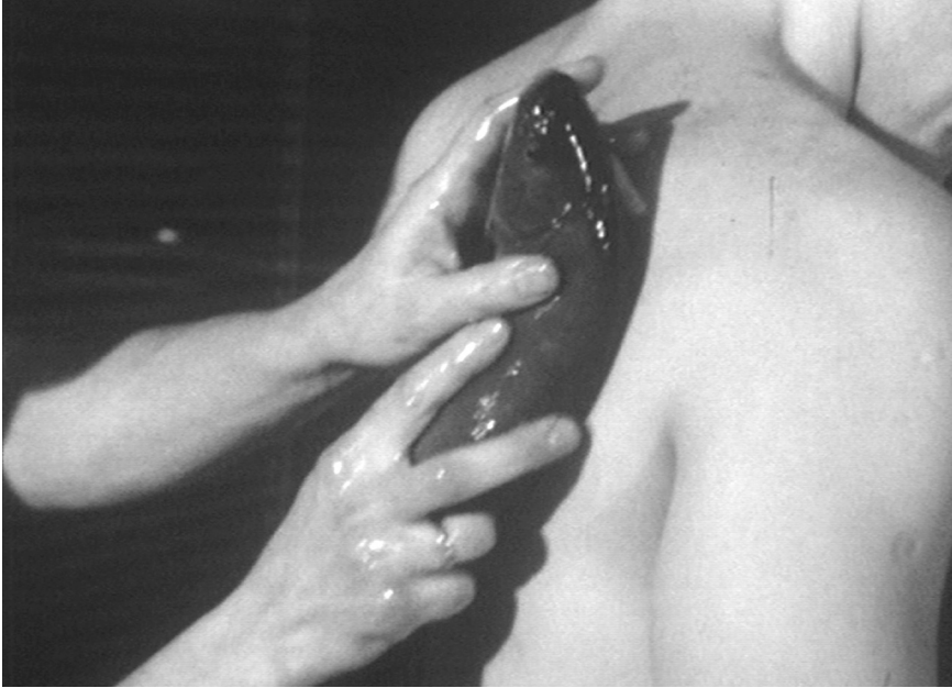
Abb. 4: Auch das war Biotech – Erprobung von Fischschleim zur Verminderung des Strömungswiderstands an einem Schwimmer, Filmstill aus: »Bilder aus der Wissenschaft«, Sender Freies Berlin, 24.1.1979.
